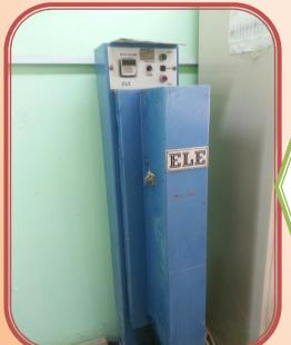
مطرقة فحص الرص الذي يستخدم لتعريض التربة الى عدد من الضربات لفحص الرص باتواعه والCBR
