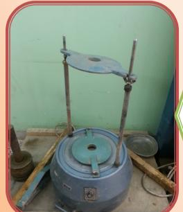
هزاز مناخل قياسي الذي يقوم بهز المناخل للقيامم بعملية الغربلة للتربلة للتربة لوقت ومقدار الهتزاز يمكن تحديده بالجهاز
