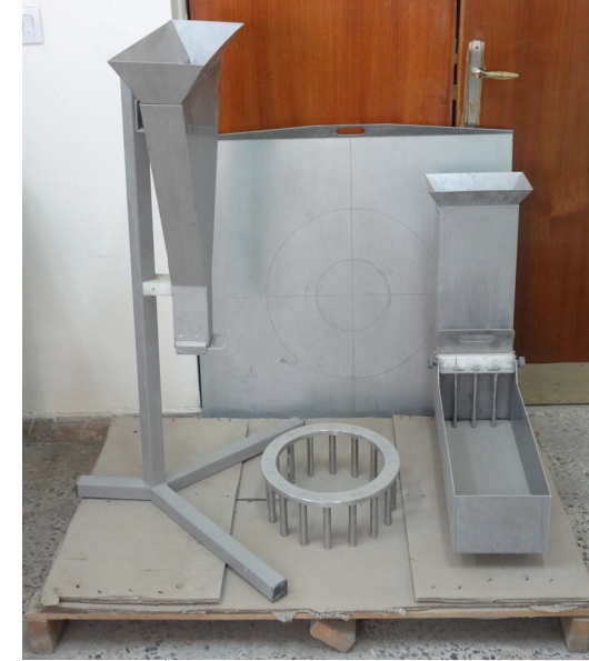
ادوات فحص قابلية تشغيل الخرسانة ذاتية الرص. Apparatus for self-compacting concrete
