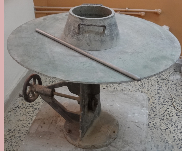
جهاز فحص الانسياب للخرسانة
