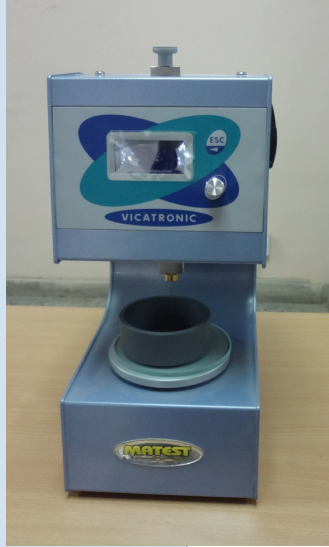
جهاز فيكات Vicat Apparatus
