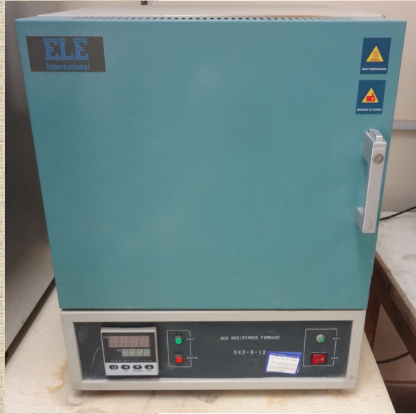
فرن حرق Muffle Furnace
