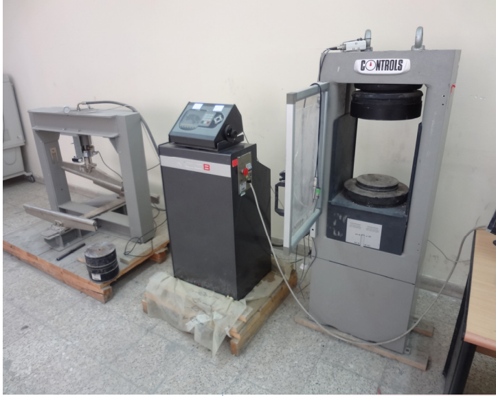
جهاز فحص الانضغاط والانثناء
