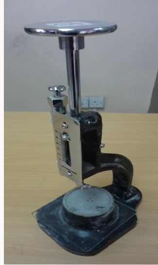
جهاز فيكات Vicat Apparatus
