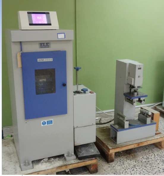
جهاز فحص الانضغاط compression machine with digital readout
