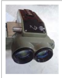
يستخدم في قياس المسافات الافقية و المائلة الكترونياً بين
